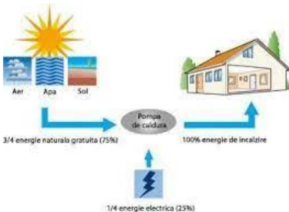
Fig. 17. Pompe de căldură
